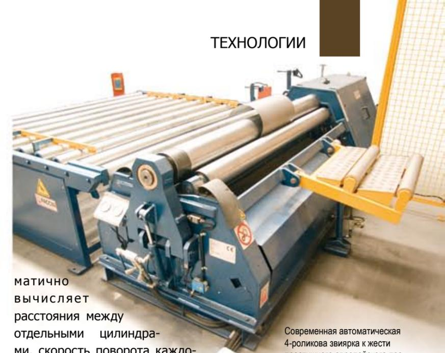
матично вычисляет расстояния между отдельными цилиндрами, скорость поворота каждого из цилиндров, продолжительность отдельных установок и промежуточные периоды между данными операциями. Оператор располагает возможностью выбрать стандартные формы (круглая, полуцилиндрическая, овальная, с открытым профилем, коническая), однако может также запрограммировать и собс-
