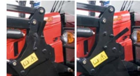
Система быстрого и уверенного крепления погрузчика
