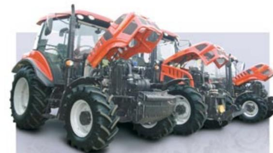
Тракторы серии P основаны на современных трансмиссиях фирмы ZF, с внутренней, управляемой электрогидравлическим способом, системой передачи. Это позволяет переключать скорости под нагрузкой (power shift) в каждом из десяти четырехскоростных диапазонов с помощью одной только кнопки. Таким образом, оператор располагает 40 передач вперед и таким же количеством – назад, тоже переключаемых под нагрузкой (т.н. power shuttle).
