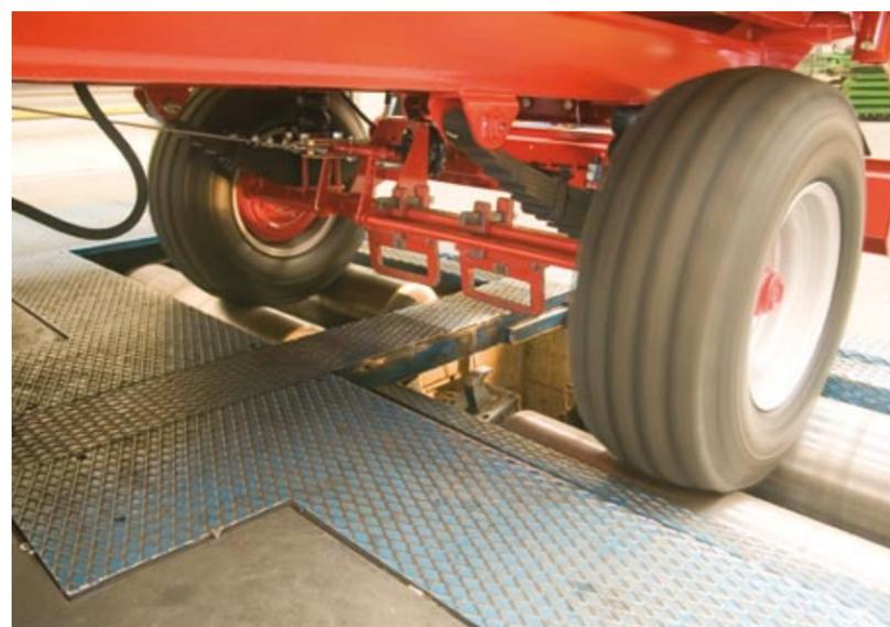
Узел добавочной нагрузки позволяет измерять силу торможения как незагруженного, так и загруженного прицепа. Специалистами Отдела по Внедрению Технологии, которые также занимаются проектированием прицепов, согласно директивам Евросоюза были разработаны нормы сил торможения для отдельных видов прицепов.
