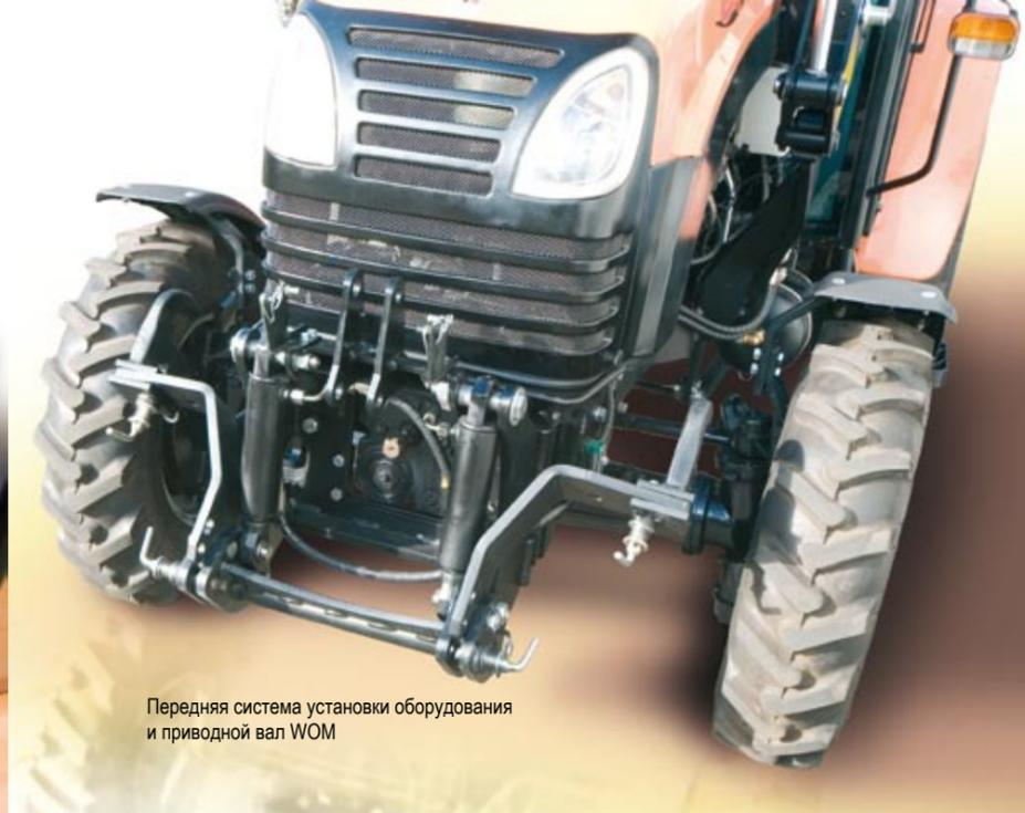
Передняя система установки оборудования и приводной вал WOM
