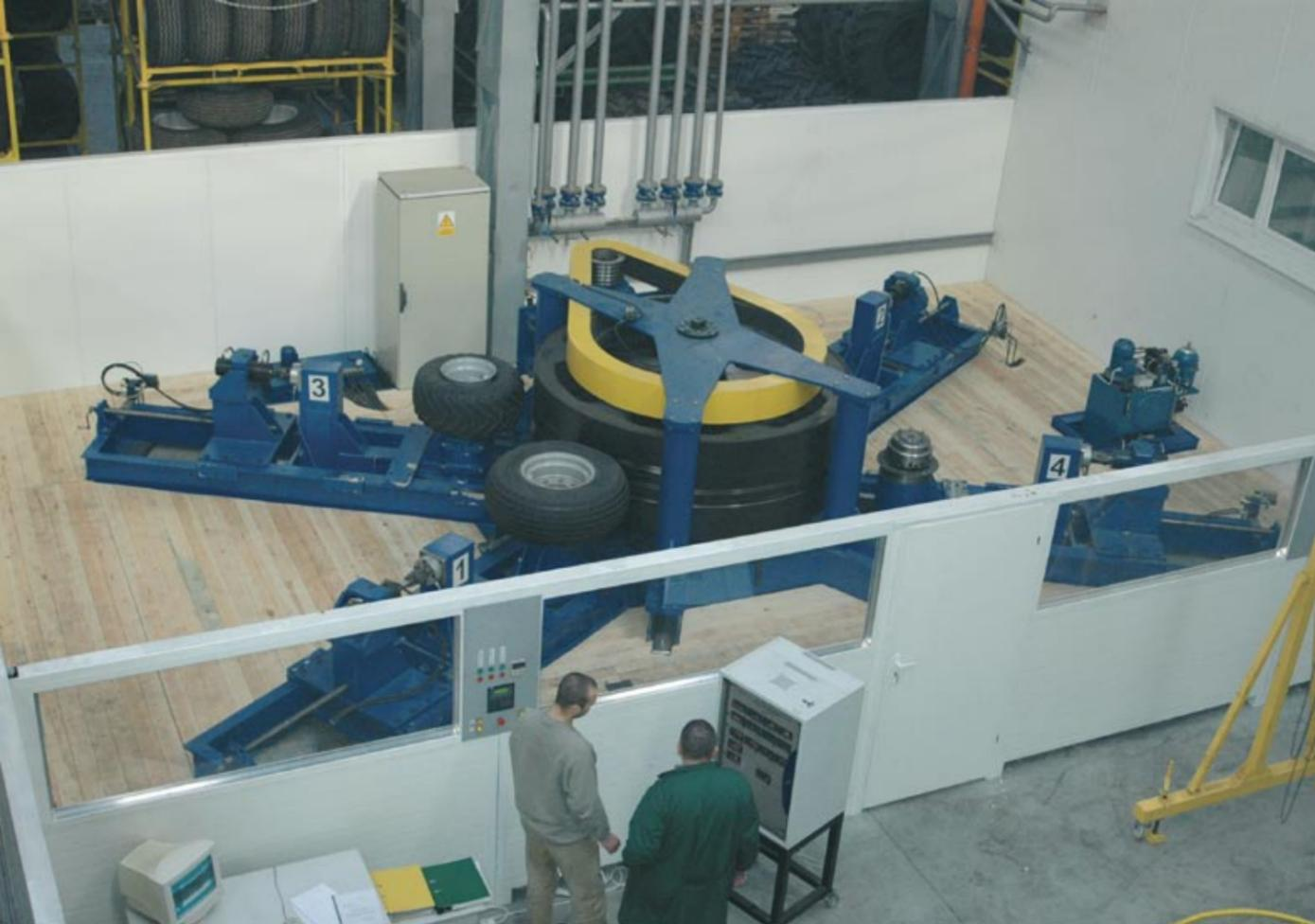
Исследовательская лаборатория - испытание колеса на радиальную нагрузку
