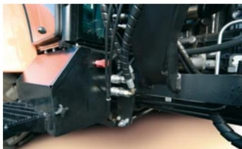
Пара соединительных гидравлических стыков с тыла
