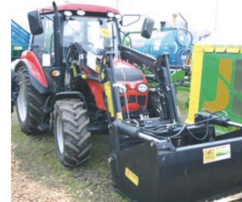
Трактор серии P5 с фронтальным погрузчиком LC-3 и устройством для уборки зеленого корма
