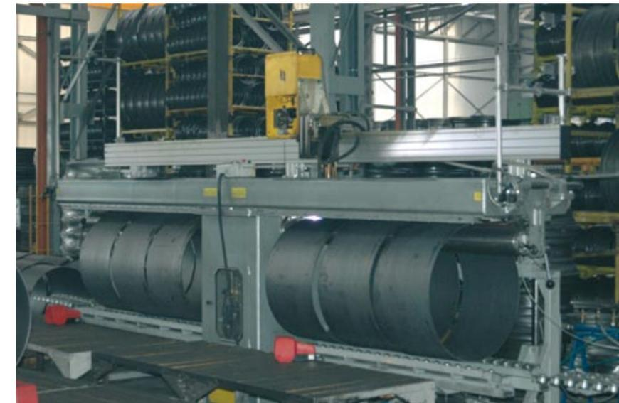
Установка для плазменной сварки колец – толщиной 16 мм.
