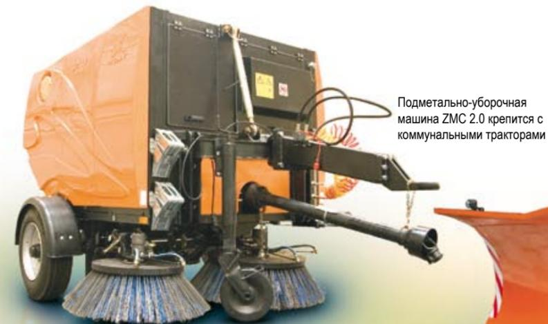
Подметально-уборочная машина ZMC 2.0 крепится с коммунальными тракторами
