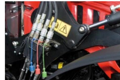
Плотный и безотказный гидравлический распределитель
