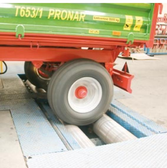
Измерение силы торможения оси не загруженной и проверка разницы сил торможения правого и левого колеса, которая не должна превышать 20%
