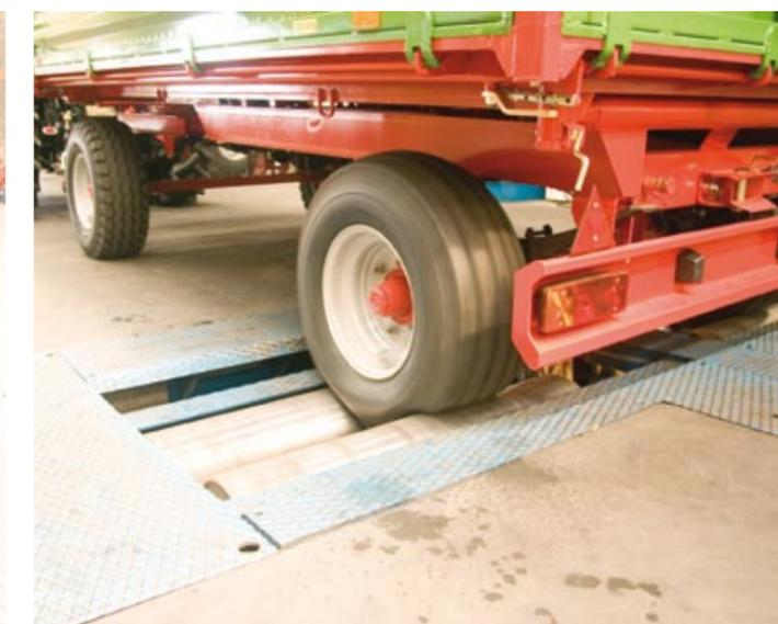
колесных осей, а зафиксированные результаты измерений позволяют проводить подробный анализ качества применяемых узлов, а также дают основания для тщательной оценки комплектующих узлов от наших поставщиков.
