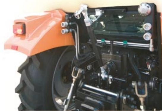
Пара передних соединительных гидравлических стыков
