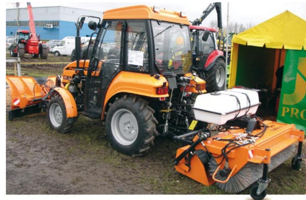
Трактор 320 АМК с плугом и подметательной машиной ZM - 1600
